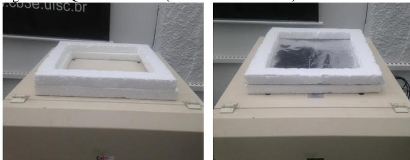
Os ensaios foram realizados variando a diferença de temperatura entre as placas quente e fria. O Quadro 5 mostra os casos avaliados, para uma diferença de temperatura entre a placa quente e a fria de 15°C, 25°C e de -15°C, simulando fluxo de calor sentido descendente e ascendente.
