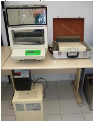
Para avaliar a influência da presença de um material de baixa emissividade na resistência térmica do ar instalou-se o isolamento reflexivo entre dois quadros de poliestireno expandido, conforme a Figura 130. Cada quadro possui a dimensão de 30 cm por 30 cm, vazado e com uma borda de espessura 2,5 cm. A altura do mesmo é de 2,5 cm.
