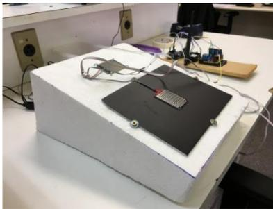
O segundo sensor é utilizado para medir apenas a presença de umidade advinda da chuva. Para garantir que não ocorra condensação superficial, esse sensor é aquecido por uma resistência planar a aproximadamente 20 °C acima da temperatura do ar.
