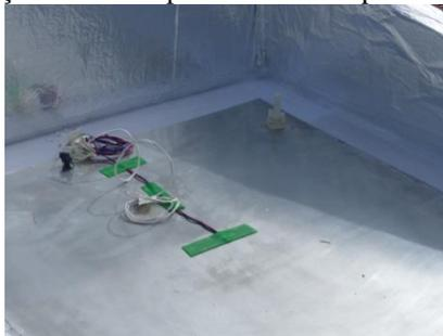
Os termopares utilizados para medir a temperatura do ar foram protegidos da radiação do entorno através de um encapsulamento ventilado fabricado com alumínio polido (diâmetro =20 mm), conforme mostrado na Figura 17 e na Figura 18.
