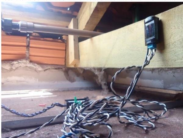
Com o auxílio de um suporte metálico, o piranômetro foi fixado na estrutura do coletor solar, assumindo o mesmo ângulo de inclinação, conforme a Figura 58.
