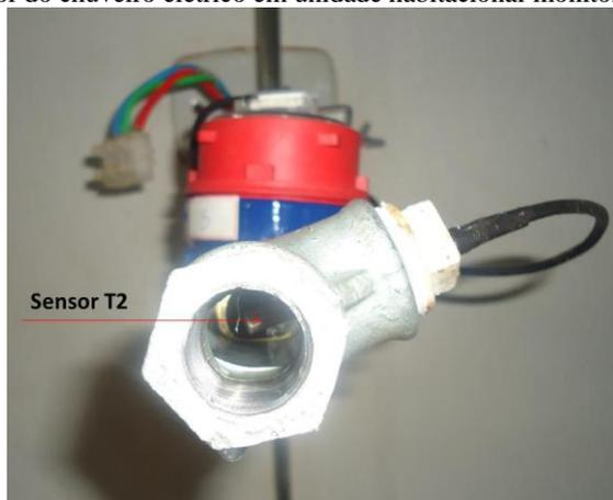
A peça plástica branca foi perfurada para a passagem do sensor T2, e vedada com cola plástica. A área de contato do cabo do sensor com a cola plástica foi protegida com uma fita isolante.
