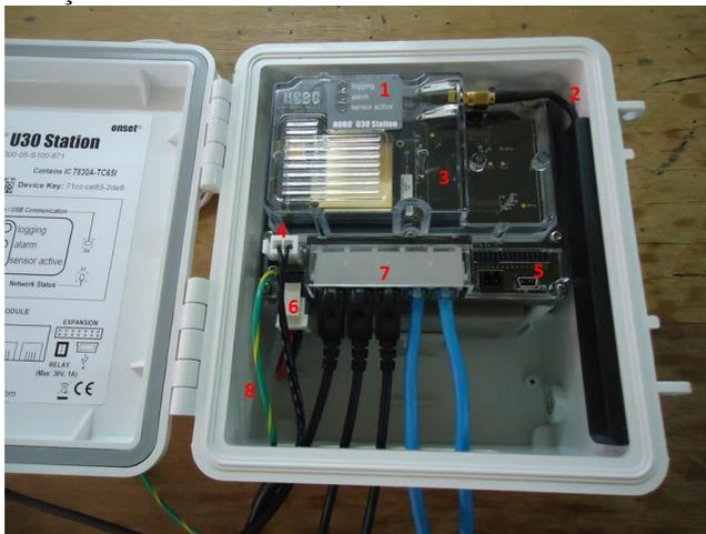
A numeração contida na Figura 41 corresponde a: 1- visor em LED indicando quando o sistema está ativo, alarmes e comunicação; 2 – antena GSM (*Global System for Mobile Communication*) para transferência dos dados via sinal de celular; 3 – armazenamento interno de dados; 4 – fonte de alimentação do sistema, 127V; 5 – entrada USB; 6 – Conexão da bateria; 7 – Entrada para conexão dos sensores; 8 – Aterramento.
