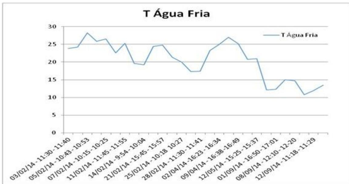
Na figura acima observa-se a variação da temperatura da água fria armazenada em reservatório superior exposto a interperie. Enquanto em fevereiro permanece na casa dos 25°C, em agosto e setembro não ultrapassou os 15°C.
