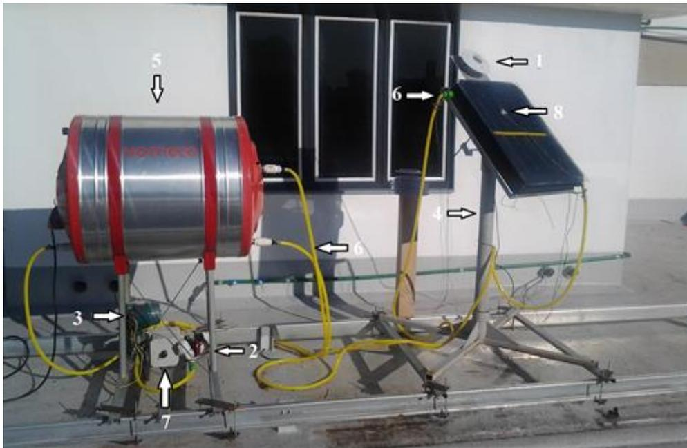
Figura 1. Imagem da bancada de teste para ensaios de desempenho térmico de coletores solares planos
