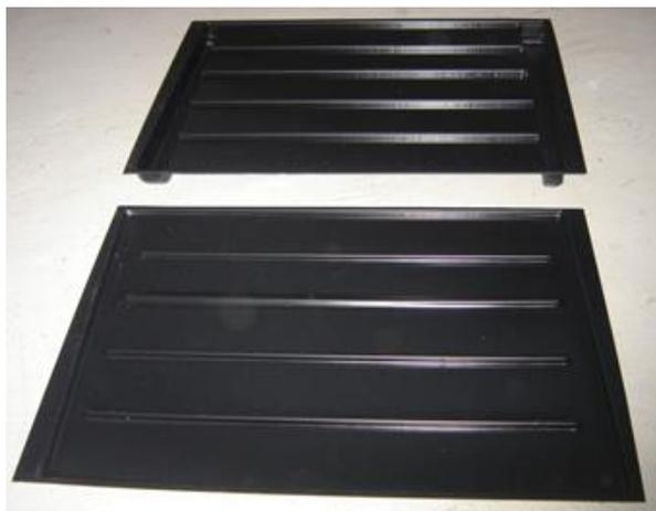
Figura 3. Protótipo de um coletor solar plano polimérico aberto
