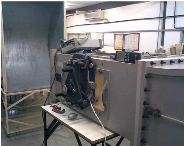
Figura 3.3 – Multímetro e anemômetro digital.
