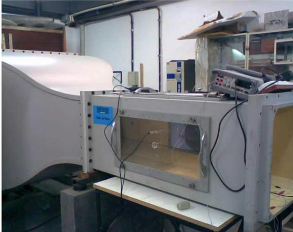
Figura 3.1 - Túnel de vento.
