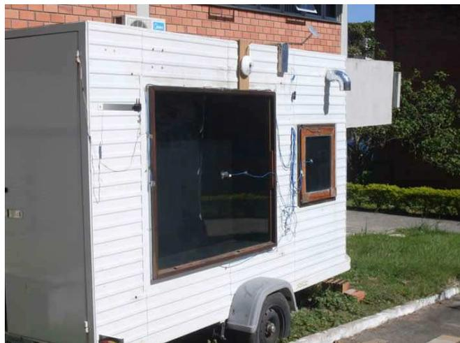
Figura 4.1 – Amostra de teste instalada no calorímetro
