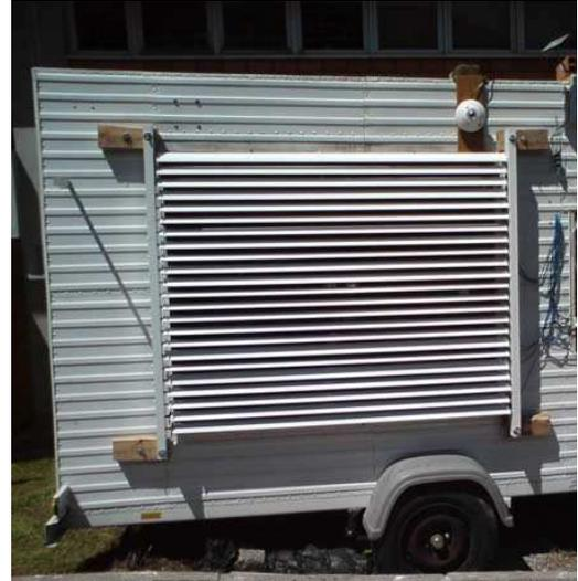
Figura 4.21 – Brise instalado no calorímetro
