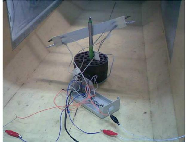
Figura 3.2 – Anemômetro no túnel de vento.
