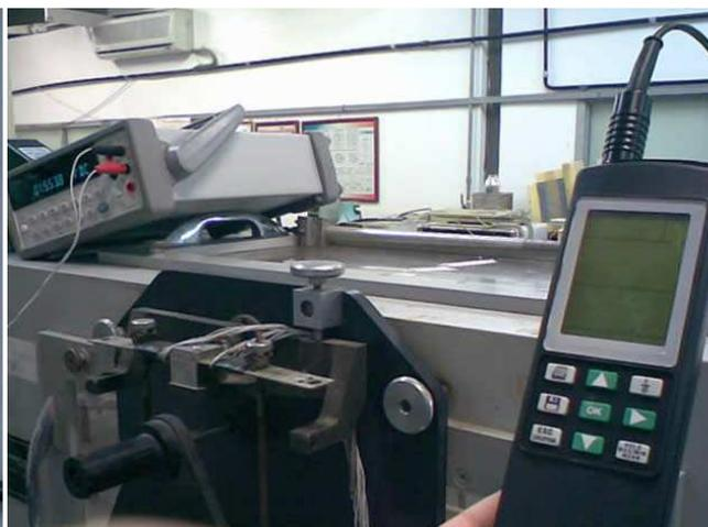
Figura 3.6 – Multímetro e anemômetro durante leitura.
