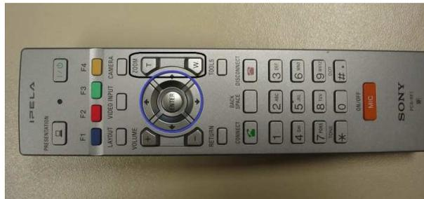
Figura 4. Detalhes do controle: zoom in (T), out (W) e as setas.
