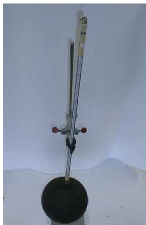
Figura 5. Termômetro de globo, utilizado para medição da temperatura de globo. Fonte: www.labcon.ufsc.br
