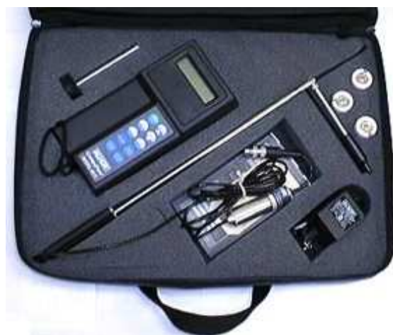
Figura 8. Termoanemômetro para medição da velocidade do ar. Fonte: www.labcon.ufsc.br
