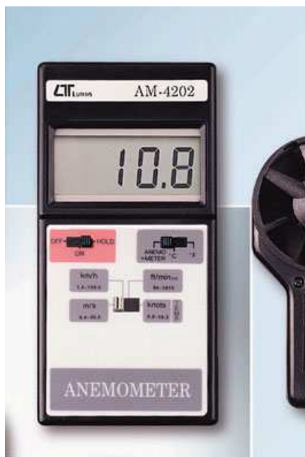
Figura 7. Anemômetro de hélice para medição da velocidade do vento. Fonte: www.labcon.ufsc.br
