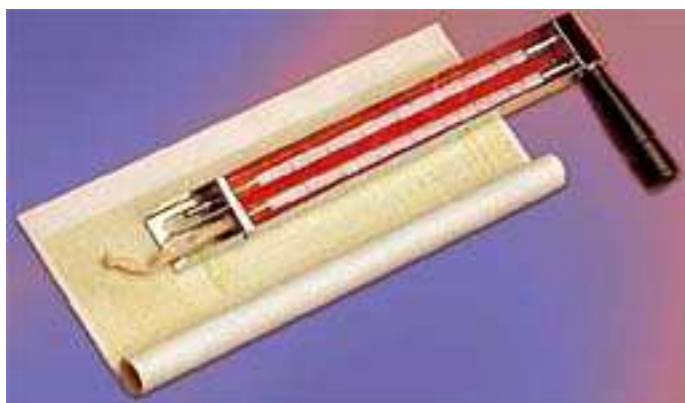
Figura 6. Psicrômetro giratório, utilizado para medição da temperatura de bulbo seco e temperatura de bulbo úmido. Fonte: www.labcon.ufsc.br
