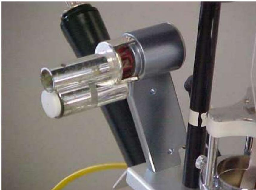
Figura 1.31 - Psicrômetro com ventilação forçada, BABUC.
