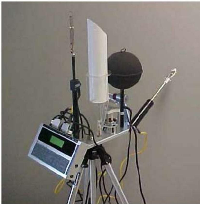
Figura 1.11 - Confortímetro BABUC.
