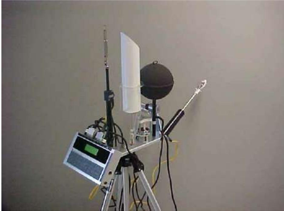
Figura 1.28 - Equipamento para medição de conforto e estresse BABUC - Itália.
