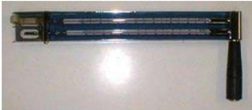
Figura 1.25 - Psicrômetro giratório - Temperatura de bulbo seco (ar) e Temperatura de bulbo úmido com ventilação.
