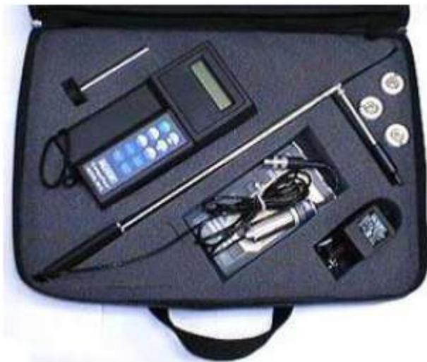
Figura 1.27 - Termoanemômetro (temperatura do ar e velocidade do ar).
