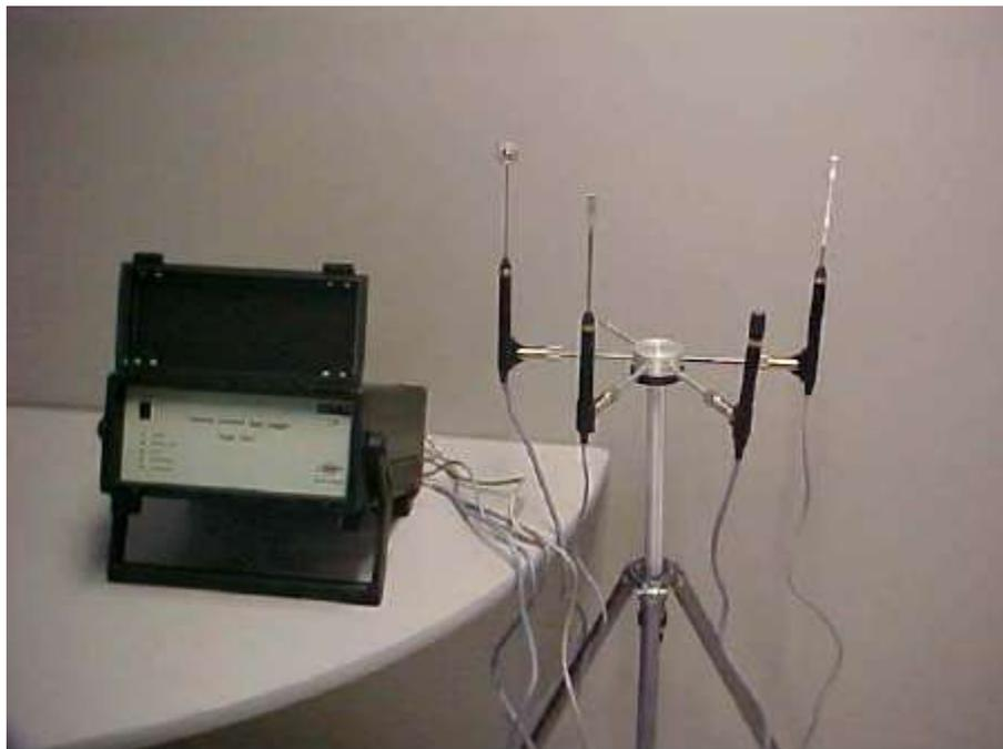
Figura 1.29 - Equipamento para medição de conforto e estresse B&K - Dinamarca.
