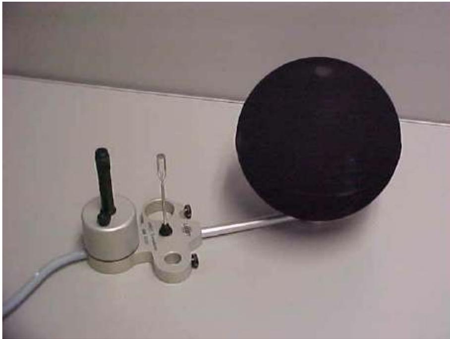
Figura 1.30 - Equipamento para medição de IBUTG - B&K.
