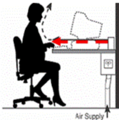
Figura 22: Ilustração de funcionamento das entradas de ar nos postos de trabalho utilizadas no edifício ZER.
