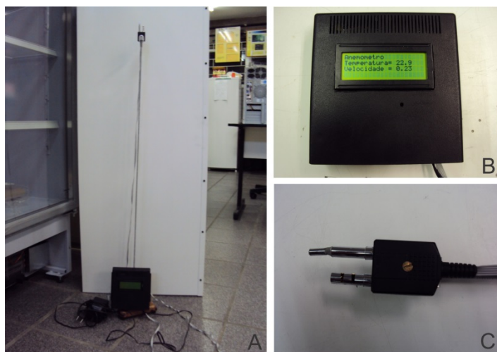
Figura 20. Termoanemômetro portátil de fio quente desenvolvido pelo LMPT. A) Imagem do conjunto do equipamento; B) Detalhe do datalogger ; C) Detalhe do sensor.
