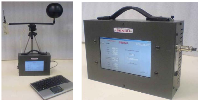
Figura 19. Confortímetro SENSU: componentes e sensores.
