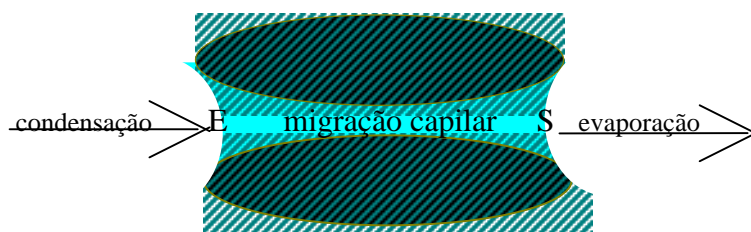
Figura 2.6: Representação da transferência de umidade através de uma ilha de líquido.
