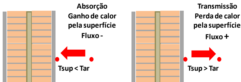
Figura 4.6 – Esquema representativo dos fluxos de calor nas superfícies internas.
