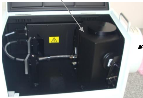
Figura 15 – Interior do espectrofotômetro Lambda 1050.
