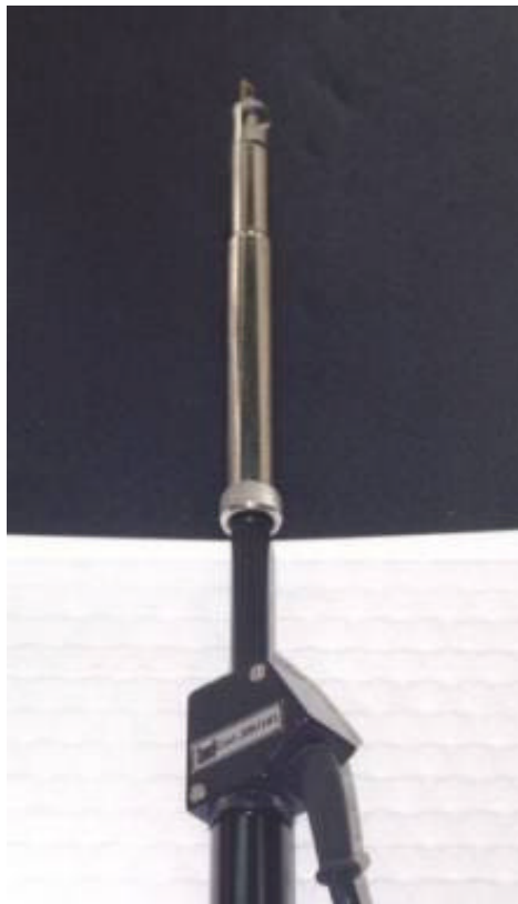
FIGURA G.6: Anemômetro de fio quente BABUC-A
