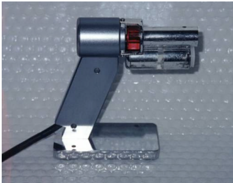
FIGURA G.4: Psicrômetro de aspiração forçada BABUC-A
