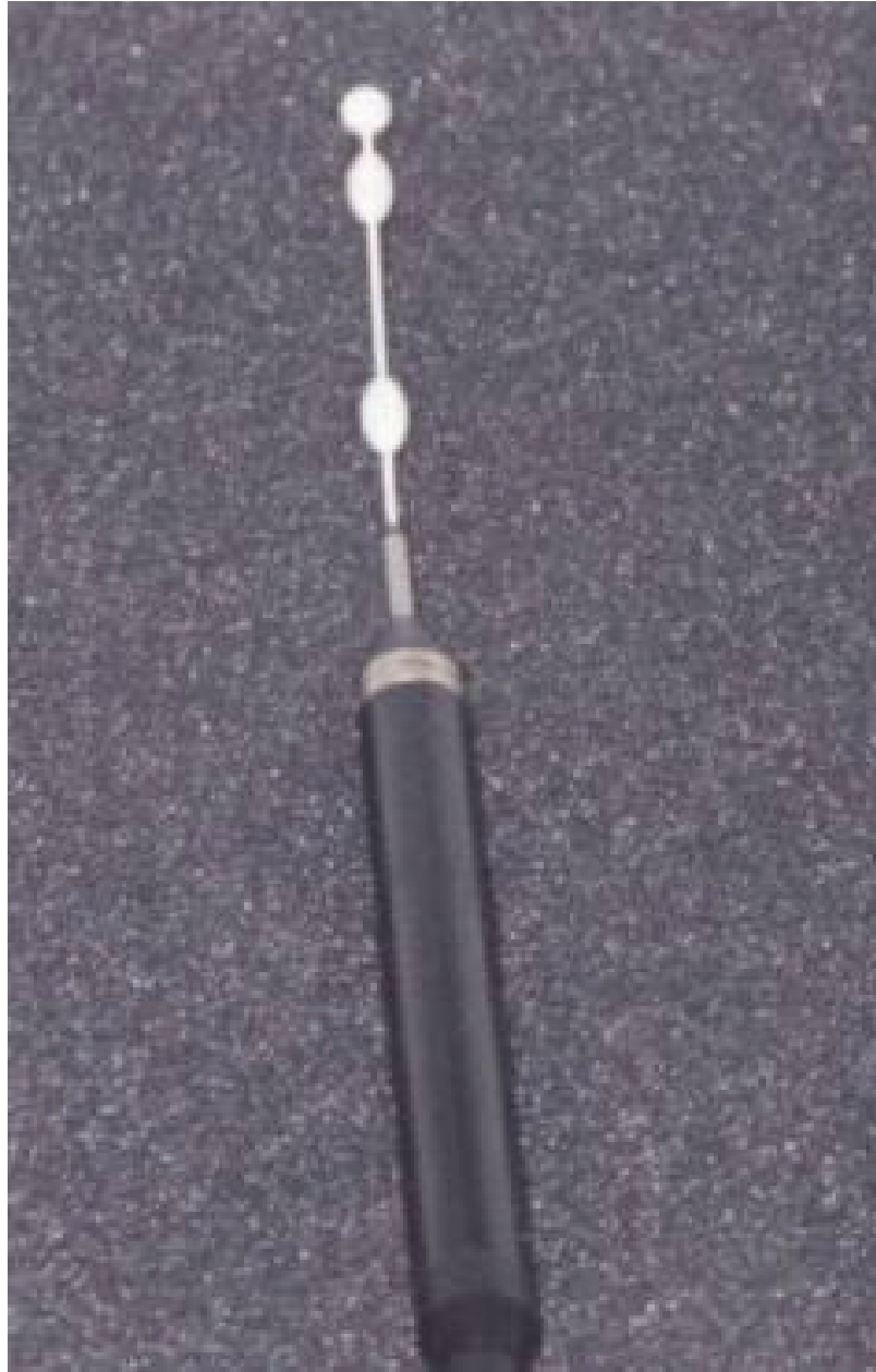
FIGURA G.11: Anemômetro a esfera aquecida do equipamento TYPE 1221.
