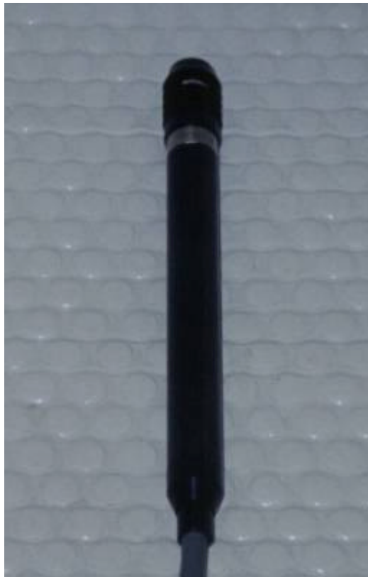
FIGURA G.10: Psicrômetro a espelho do equipamento TYPE 1221
