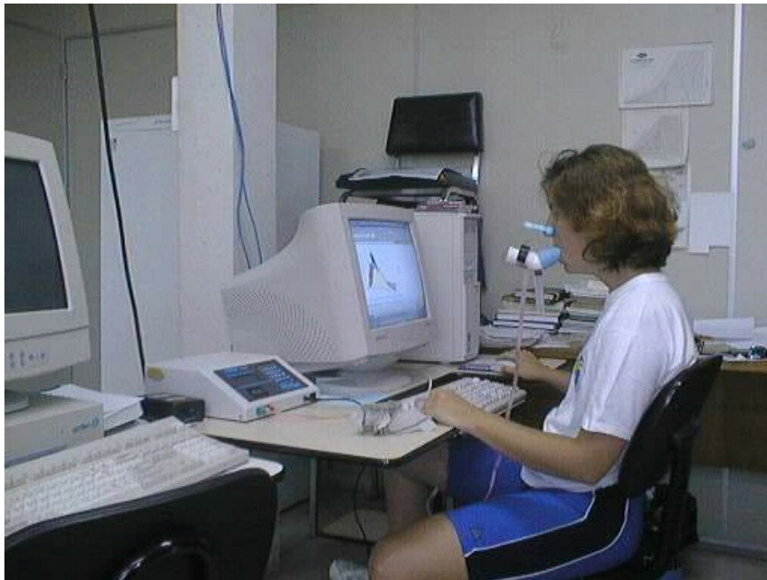
FIGURA 3.1: Processo de medição do consumo de O_2 , realizado no LabEEEE
