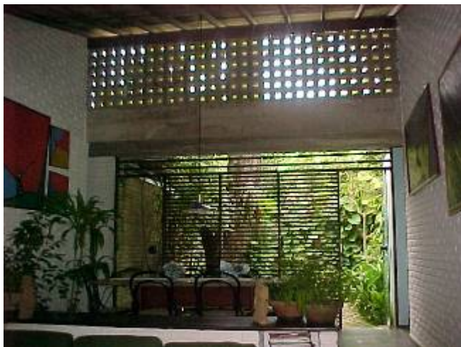
Figura 4-13 - Casa de Leonardo Bittencourt em Maceió, Nordeste do Brasil. Aberturas para a ventilação natural, extraindo o calor gerado pela cobertura escura.
