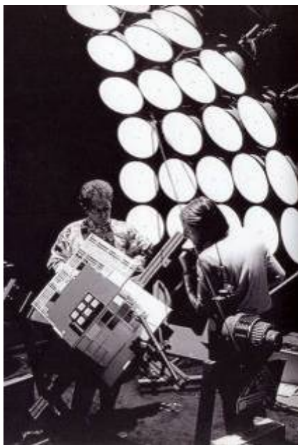
Figura 4-22 - Uso de céu artificial para analisar efeitos da luz natural em maquete física. Fonte: Cucinella, 2004
