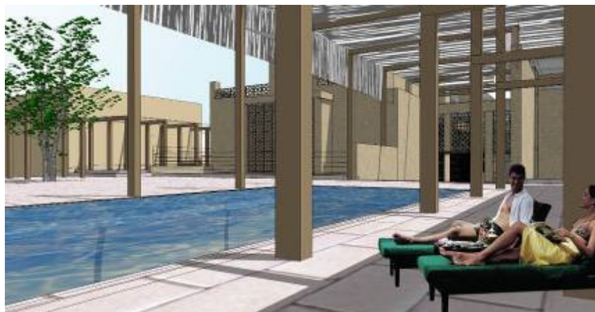
Figura 3-53- Estratégias de Proteção solar - pergolas e cobogós ao fundo.
