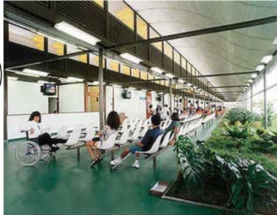
Figura 3-5- Sala de espera– iluminação natural e jardim interno(resfriamento evaporativo)
