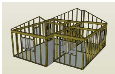
Figura 134– Estrutura em madeira para a casa que usa paredes em madeira (PAR5)
