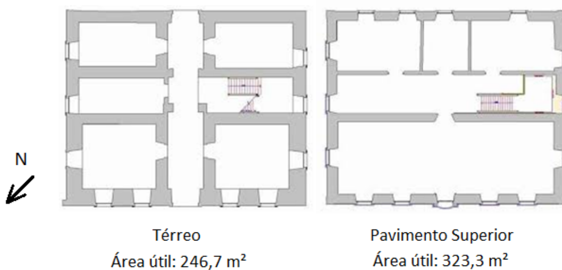
Figura 2 - Planta baixa do térreo e do pavimento superior do edifício em estudo
