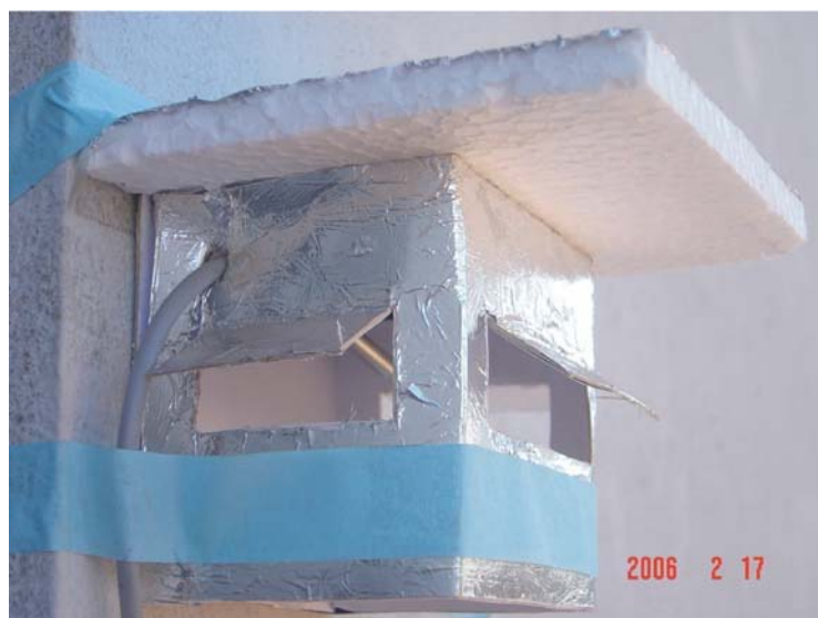
Figura 5.1. Proteção Contra Radiação
