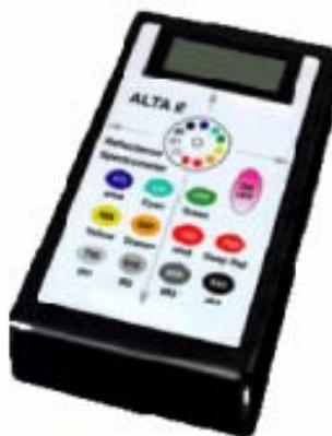
**Figura 2.2.** Aparelho utilizado para a medição das refletâncias.
