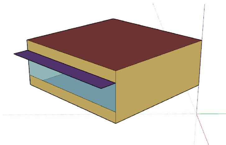
Para modelar essa zona, considerou-se as paredes correspondentes a superfícies voltadas para outros escritórios como adiabáticas (sem trocas de calor). A superfície que representa a parede voltada para a circulação foi avaliada com duas condições de contorno: 1) como adiabática, e 2) como *outdoors*, sem incidência de vento ou sol
