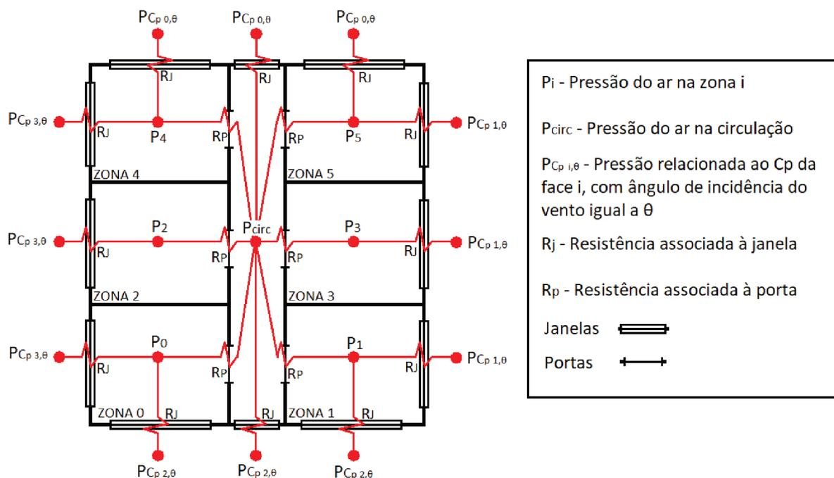
Figura 11 – Rede de fluxo de ar na simulação simplificada
