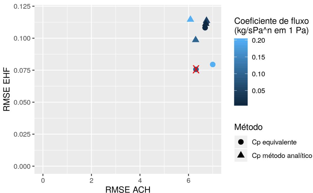
Figura 21 – Comparação entre os resultados de ACH e EHF para coeficiente de vazão mássica de ar com valor igual 0,1 kg/sPa^n em 1 Pa
