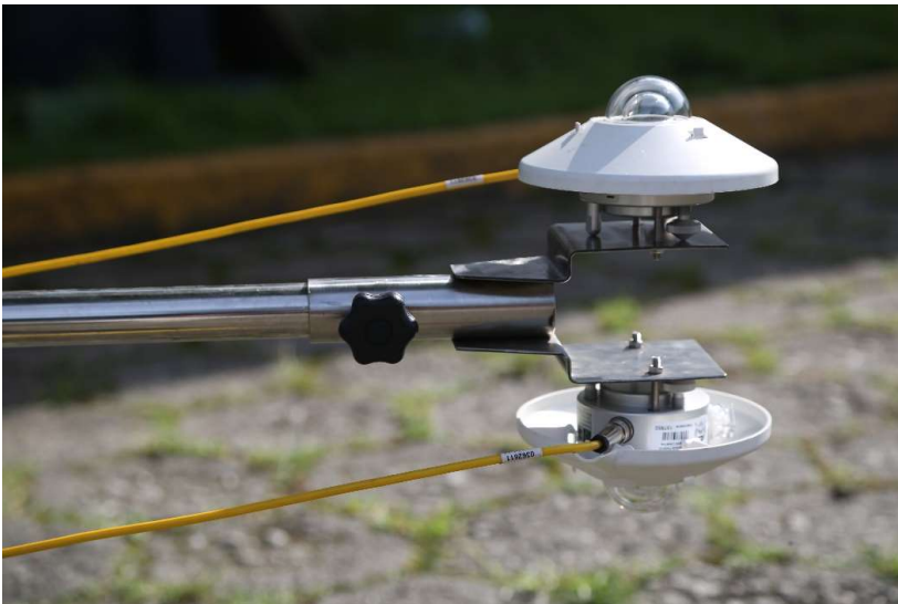
Figura 3.4– Detalhe de montagem dos dois piranômetros.
