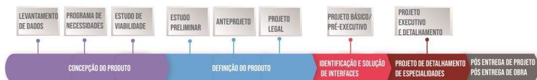
Figura 7: Etapas de projeto definido no manual de desenvolvimento e contratação de projetos
