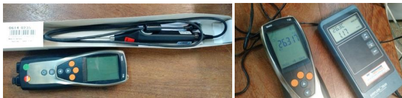
Figura 86 – Sensor Testo (esq.) e a comparação de T_{ar} entre Testo e AIRFLOW
