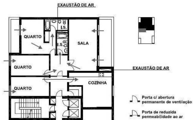
Figura 2.69: Esquema de uma solução de ventilação separada. Neste caso existem dois sectores distintos de ventilação [62].
