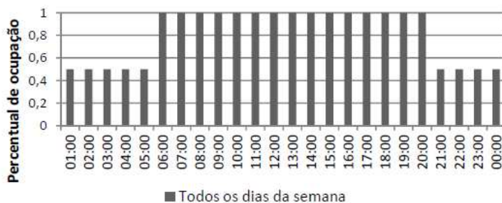
Figura 74. Padrão de Iluminação da cozinha.
