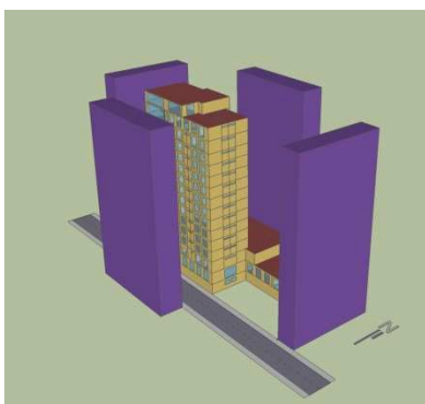
Obstrução das quatro fachadas (densidade baixa)
