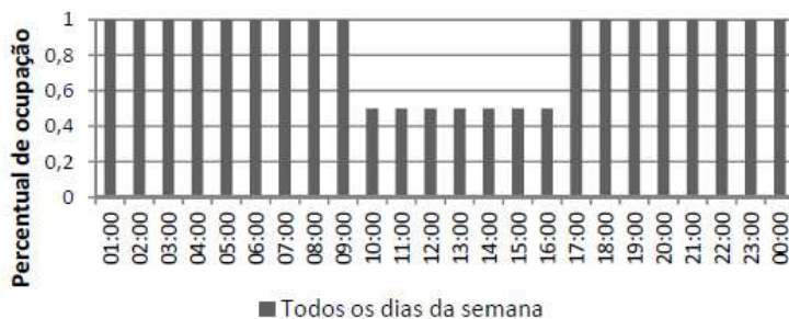
Figura 77. Padrão de Iluminação das áreas de circulação.
