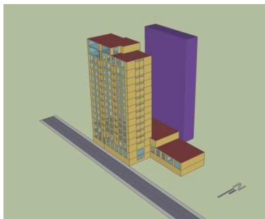
Obstrução da fachada posterior (norte)
