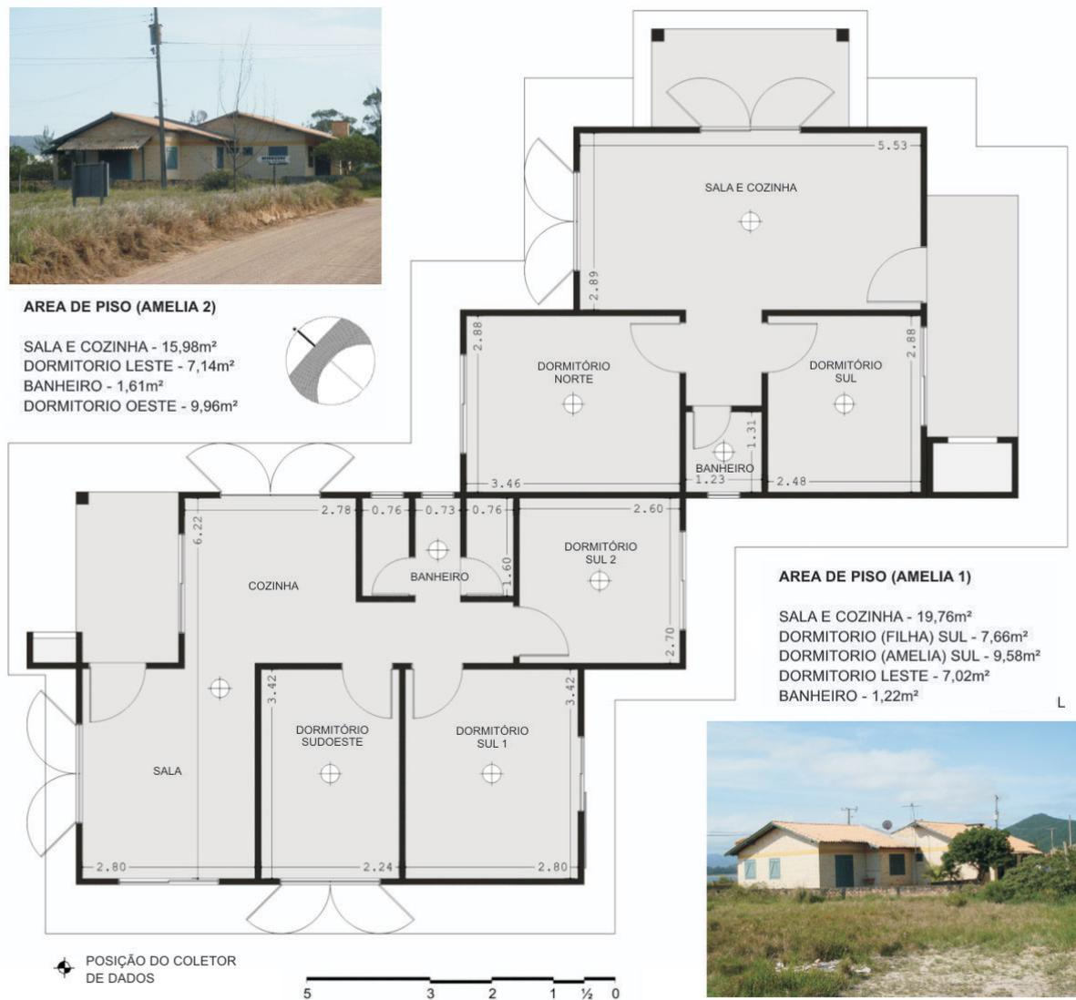
**Figura 5** – Fotos, planta baixa e a posição dos coletores de dados dos ambientes monitorados, sendo cinco da Edificação A1 (esq.) e quatro da Edificação A2 (dir.).
