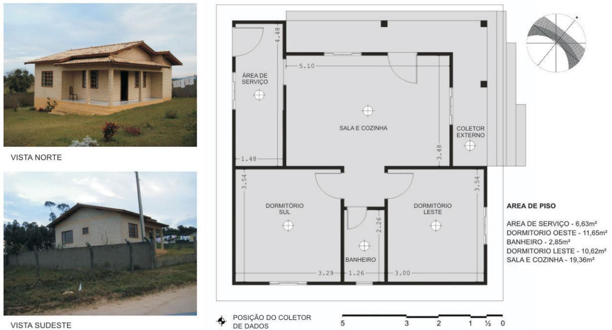
**Figura 6** – Fotos, planta baixa e a posição dos coletores de dados dos cinco ambientes monitorados da Edificação B, mais o coletor de dados das variações climáticas externas.
