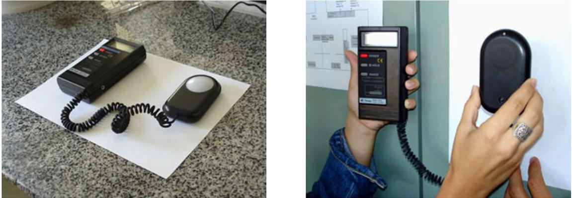
**Figura 4** – Luxímetro utilizado para verificar a iluminância refletida pelas superfícies externas das edificações.
