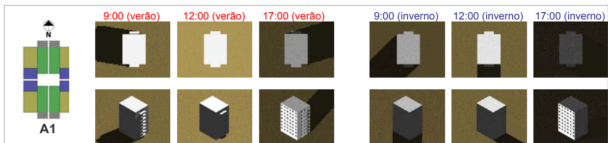
Figura K1 – Estudo de insolação (hora solar) – verão (21/12) / inverno (21/06) – Tipologia A1. Fonte: imagens da autora – software Autocad 2000.
