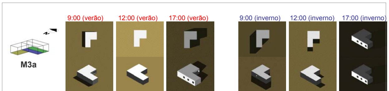
Figura K8 – Estudo de insolação (hora solar) – verão (21/12) / inverno (21/06) – Tipologia M3a. Fonte: imagens da autora – software Autocad 2000.
