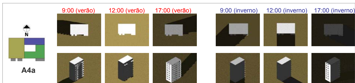
Figura K4 – Estudo de insolação (hora solar) – verão (21/12) / inverno (21/06) – Tipologia A4a. Fonte: imagens da autora – software Autocad 2000.
