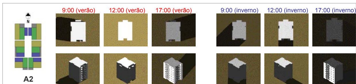
Figura K2 – Estudo de insolação (hora solar) – verão (21/12) / inverno (21/06) – Tipologia A2. Fonte: imagens da autora – software Autocad 2000.
