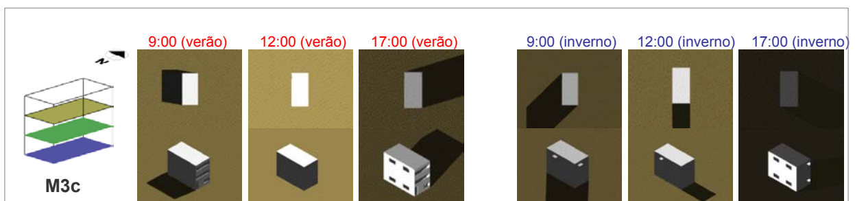
Figura K10 – Estudo de insolação (hora solar) – verão (21/12) / inverno (21/06) – Tipologia M3c. Fonte: imagens da autora – software Autocad 2000.
