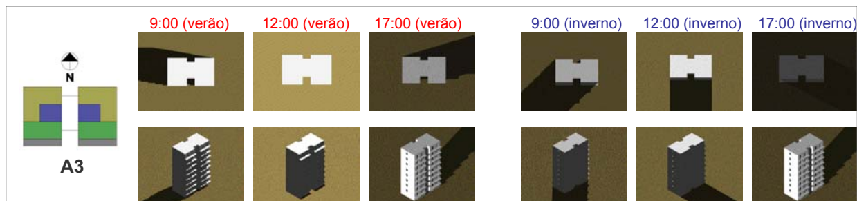
Figura K3 – Estudo de insolação (hora solar) – verão (21/12) / inverno (21/06) – Tipologia A3. Fonte: imagens da autora – software Autocad 2000.
