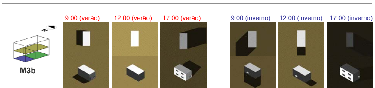
Figura K9 – Estudo de insolação (hora solar) – verão (21/12) / inverno (21/06) – Tipologia M3b. Fonte: imagens da autora – software Autocad 2000.
