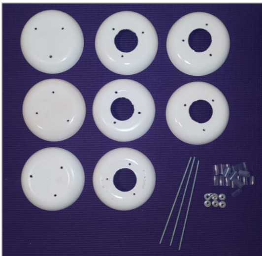
Figura A - 1 - Materiais utilizados para a montagem do abrigo
