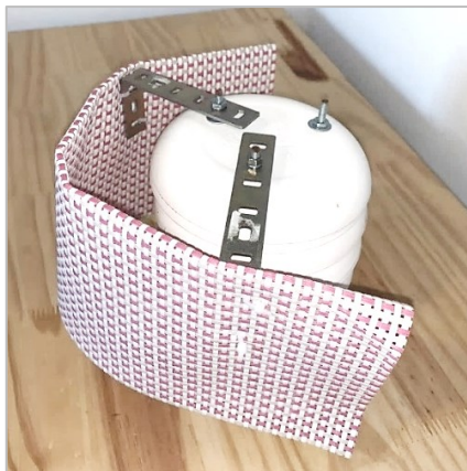
Figura A - 6 - Abrigo meteorológico com o dispositivo de proteção adicional
