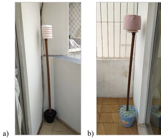
Figura A - 7 - Equipamento instalado a) no ponto A2 no inverno, b) no ponto B na primavera
