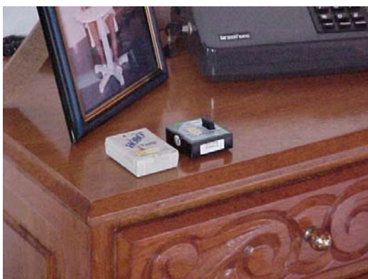
FIGURA 3.5 – Hobos de temperatura e umidade – dormitório da residência 01.
