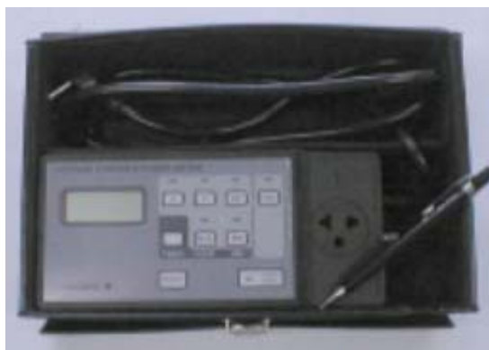
FIGURA 3.7 - Medidor portátil de consumo de energia elétrica – Yokogawa
