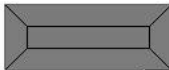
FIGURA 25 - Planta das cinco zonas condicionadas dos protótipos 49 e 79.
