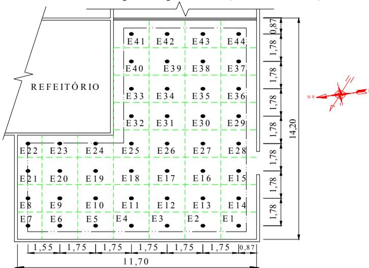
Figura 73. Malha de pontos para medição no interior do pavimento térreo.
