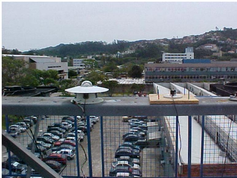
Figura 46. Piranômetros Eppley e Li-cor posicionados lado-a-lado para a calibração.
