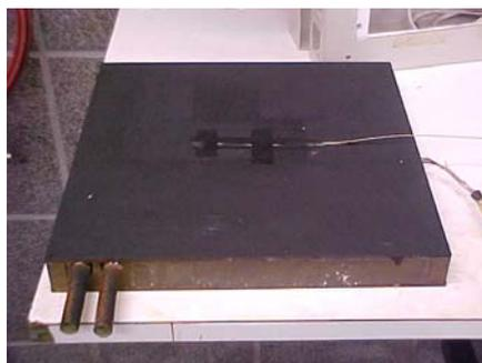
Figura 34. Placa de circulação de água.
