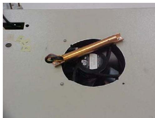
**Figura 45.** Junção de referência dos termopares na entrada do ventilador.
