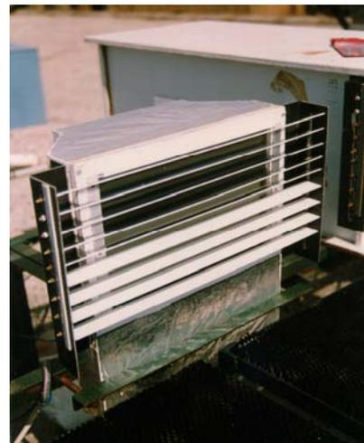
**Figura 27. Fenestration Radiometer.**
