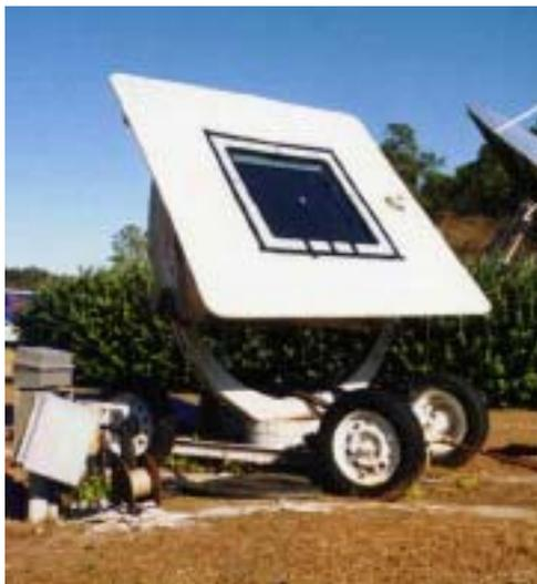
**Figura 20.** UF - ASHRAE Solar calorimeter. Fonte: SEECL, 2000.
