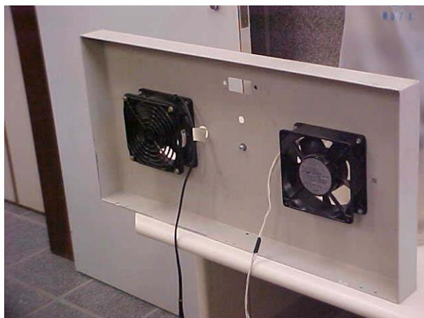
Figura 32. Posição dos ventiladores.
