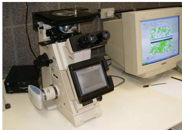
Ilustração 11 – Microscópio Olympus PME3 e software Motic Images Advanced 3.1
