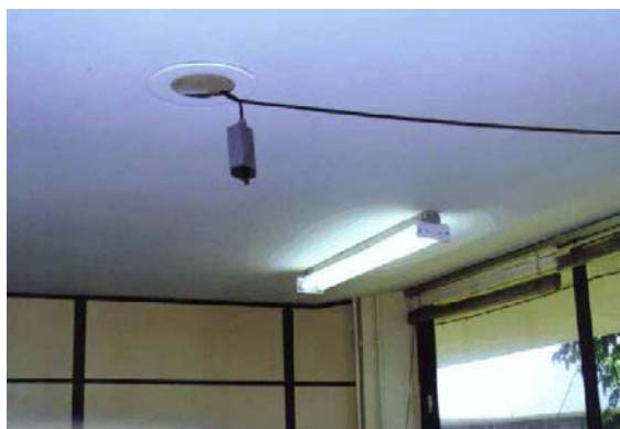
FIGURA3.28- Sensor de temperatura do ar e umidade relativa, sala N.
