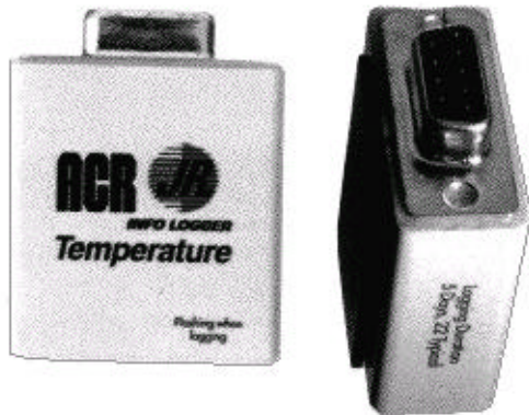
Figura 3.4 - Sistema de aquisição de temperatura Junior, da ACR.
