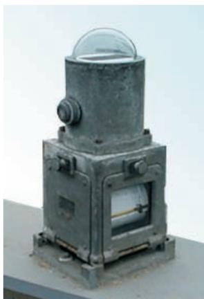
Figura 8 – Piranômetro com elemento bimetálico (Robitzch-Fuess), também conhecido como actinógrafo. (CRESESB, 2003).
