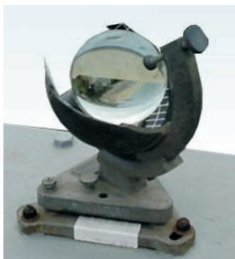
Figura 5 – Heliógrafo de Campbell-Stokes. (LABORATORIO DE EVALUACIÓN SOLAR, 2006).
