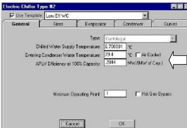
**Figura 23 – Folder que caracteriza a eficiência de um resfriador de líquido.**
