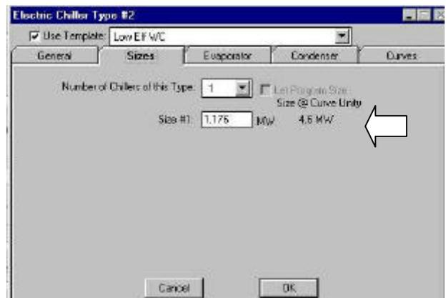
**Figura 24 - Folder que caracteriza a capacidade de um tipo de resfriador de líquido.**
