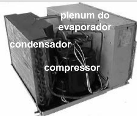
**Figura 55 – Detalhe dos elementos do condicionador de ar.**
