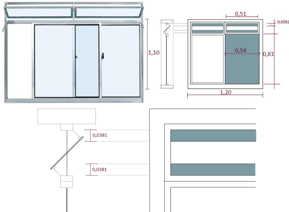
Figura 6 – Exemplo de janela para a determinação da área efetiva para ventilação. Fonte: INMETRO (2014).
